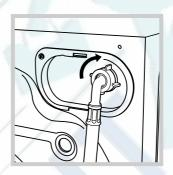
1. Подсоедините шланга к машине, привинтив его к специальному крану, расположенному в заднеи верхнеи части справа (см. рисунок).
