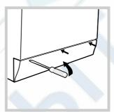
3. снимите нижний плинтус стиральнои машины при помощи отвертки (см. рисунок).
