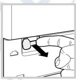
4. потяните наружу язычок, показанныи на рисунке, вплоть до освобождения пластикового блокировочного винта. Затем потяните его вниз, пока не услышите щелчок, что означает разблокировку люка.
