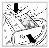
Чтобы вынуть дозатор, нажмите на язычок (1) и вытащите дозатор (2) (см. рисунок). Промыть ячеику под струеи воды. Эта операция должна выполняться.
