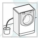
1. выньте штепсельную вилку машины из электророзетки. 2. проверьте, чтобы уровень воды в машине был ниже отверстия люка. В противном случае слеите излишек воды через сливной шланг в ведро, как показано на рисунке.
